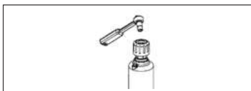
Рис. 11. Настройка перепада давления производится стандартными ключами
